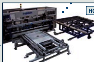
4. Автоматически устанавливаемая оснастка
